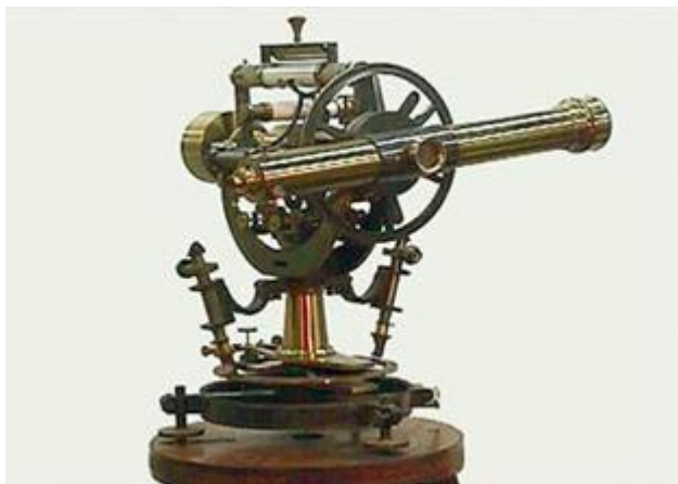
figura 3.14. Com a luneta na posição M aponta-se para A, com a luneta na posição N aponta-se B, obtendo-se H_1 (o teodolito está estacionado no ponto O)
